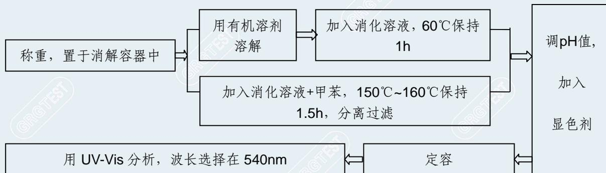
多溴联苯、多溴二苯醚测试流程:
