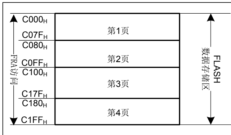
图 3-2 FLASH 数据存储区寻址空间映射图
