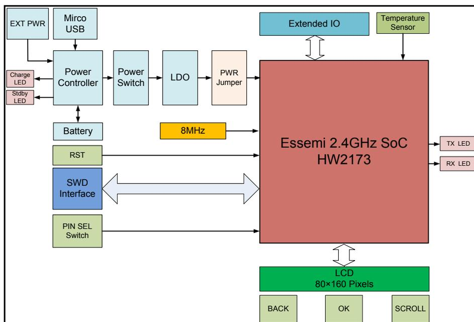
图 2-1 HW2173 开发板硬件系统结构图
